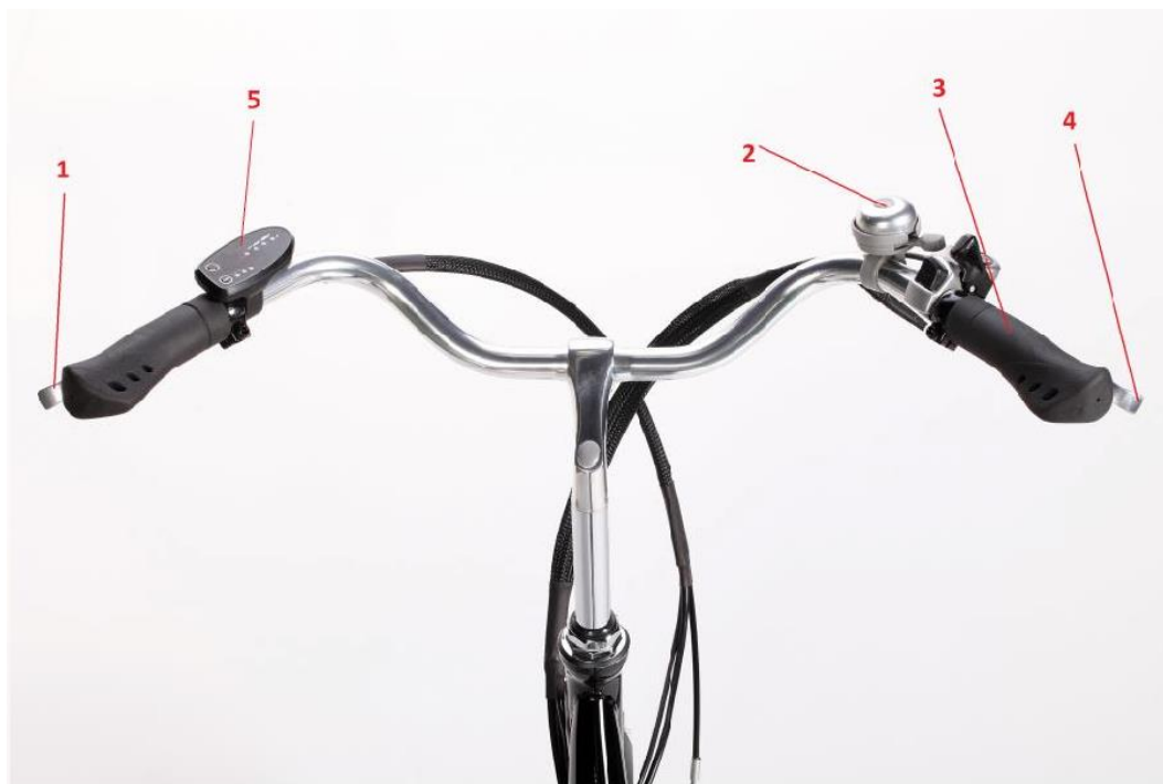
1. Bal oldali fékkar 2. Hangjelző 1. Fogantyú 2. Jobb oldali fékkar 5. Vezérlőpult
